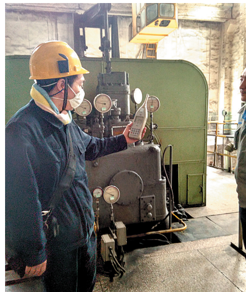
↑4月12~17日,安阳市疾控中心派人赴安阳化学工业集团有限公司进行职业病危害因素监测。专业技术人员在主要供汽车间、热电车间、循环水车间等进行采样,对粉尘总浓度和个体粉尘浓度以及噪声等进行监测。
