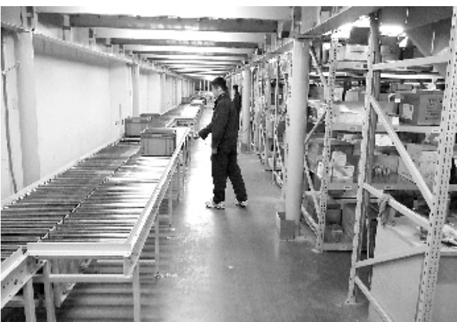
医药流通企业的工作人员正在操作间通过自动传输系统配送药品。
